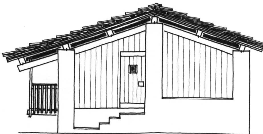
la chiusura dello sfondato è realizzata con un tamponamento ligneo posizionato in accentuato arretramento rispetto al piano di facciata al fine del mantenimento dell'effetto plastico delle parti in muratura
